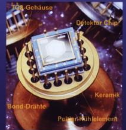
Photographie des Detektor-Moduls
